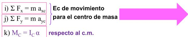
Si hay cuerpos puntuales vinculados al cuerpo rígido (x cuerdas por ej,) puede ser mas útil plantear la 2<sup>da</sup> ley de Newton para los cuerpos puntuales
