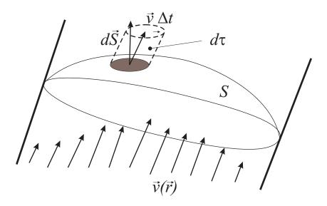
En efecto, si fijamos un intervalo de tiempo  $\Delta t$  las partículas de fluido recorren una distancia  $\vec{v}\Delta t$ , donde  $\vec{v}$  es la velocidad en un determinado punto. El volumen elemental de fluido que atraviesa una superficie elemental  $d\vec{S}$  tomada en un punto de la sección durante ese intervalo de tiempo es
