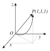
Una circulación elemental expresada en coordenadas cartesianas es  $d\Gamma = \vec{F} \cdot d\vec{r} = F_x dx + F_y dy + F_z dz$ . Debemos parametrizar convenientemente ambos recorridos:
