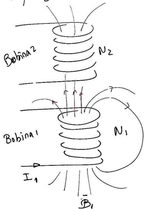
la bobina 1 transporta una corriente  $I_1$  y genera un campo  $\vec{B}_1$ .
