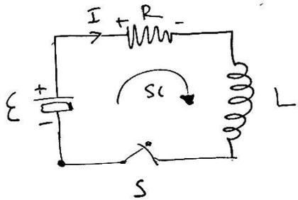
Cuando cerramos el interruptor  $\frac{dI}{dt} > 0 \Rightarrow$  el incremento de corriente se ve afectado por la inductancia  $L$
