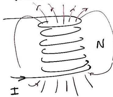
Si la corriente  $I = \text{cte} \Rightarrow \phi_B = \text{cte}$ . Sin embargo si  $I(t)$  varía con el tiempo,  $\vec{B}$  y por lo tanto  $\phi_B$  varía con el tiempo y de acuerdo con la ley de Faraday se induce una fem en la bobina que tiende a oponerse al cambio, es decir
